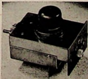
UKW-Einsteckteil mit Röhrensockel (Nora)
