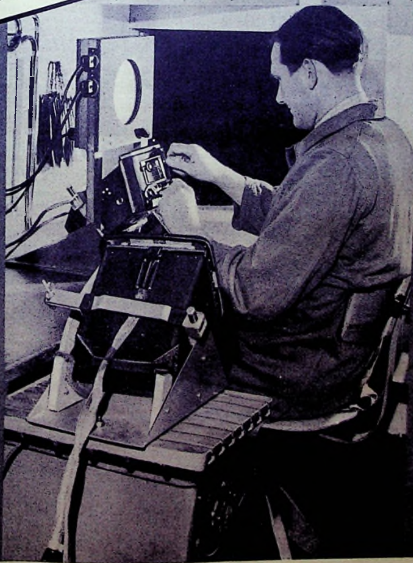
„Autosuper im Examen“. Die Empfänger werden auf dem Schütteltisch (links) und am Meßstand (rechts) empfangsmäßig auf Herz und Nieren geprüft. Aufnahme aus der Telefunken-Autosuper-Fertigung. (Foto: Carl Stumpf).
